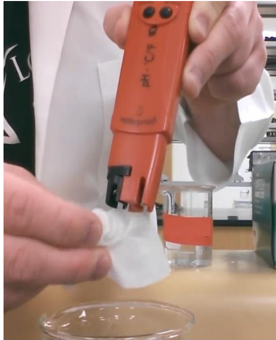
Thấm khô điện cực bằng giấy mềm
