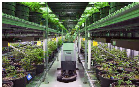
Hình 1.6.48. Vệ sinh nền nhà màng bằng máy lau nền và hóa chất tẩy rửa
