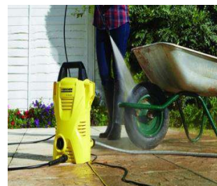
Hình 1.6.1. Dùng máy xịt rửa áp lực cao chạy điện để vệ sinh nông cụ
