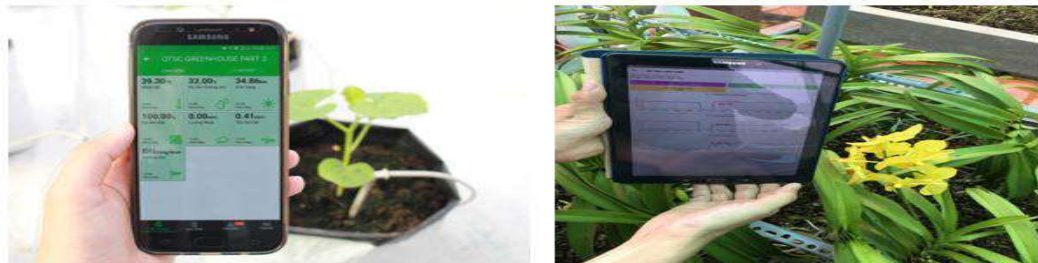
Hình 1.1.35. Giám sát các số liệu môi trường nhà màng qua ứng dụng cài đặt trên smartphone và máy tính bảng
