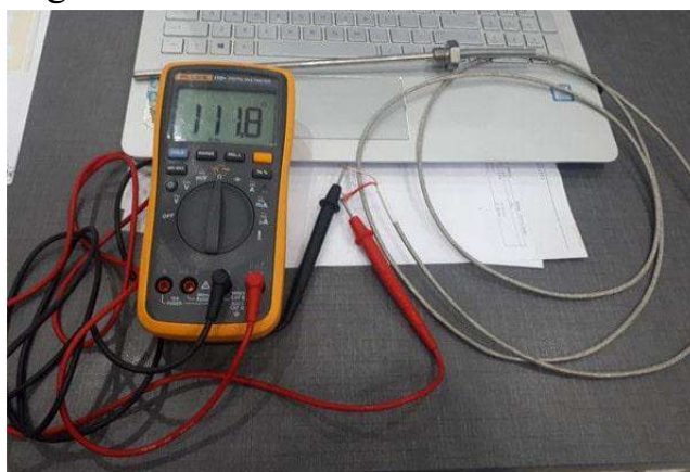
Hình 1.4.18. Thiết bị kiểm tra hoạt động của cảm biến nhiệt độ
