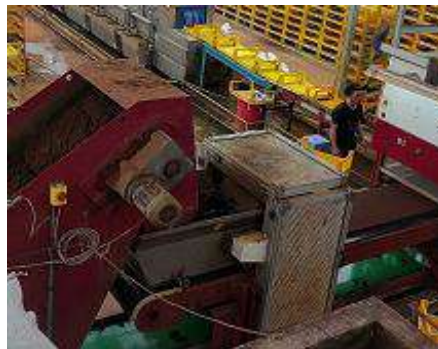
Hình 2.2.38. Dây chuyền máy đóng giá thể, tạo lỗ gieo hạt
