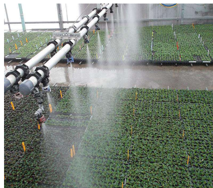
Hình 2.4.19. Hệ thống phun phân tự động
