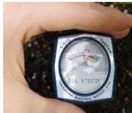
Hình 2.2.54. Kiểm tra độ ẩm giá thể trồng bằng ẩm kế
