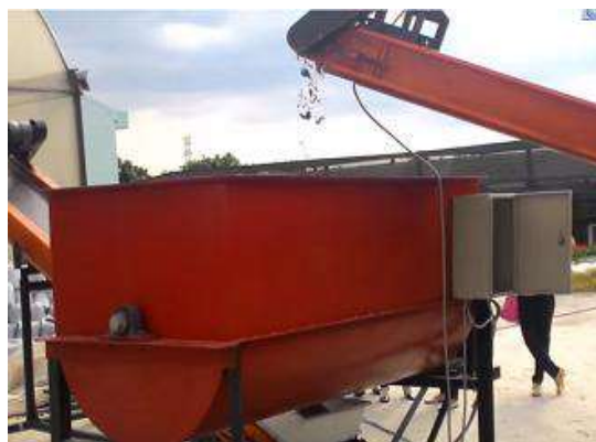
Hình 3.2.17. Băng tải chuyển nguyên phụ liệu
