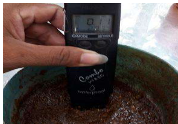
Hình 3.2.14. Đo độ EC xơ dừa sau xử lý
