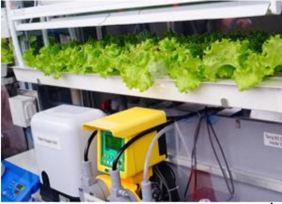
Hình 2.12. Máy giám sát, tự động điều chỉnh nồng độ dung dịch thủy canh
